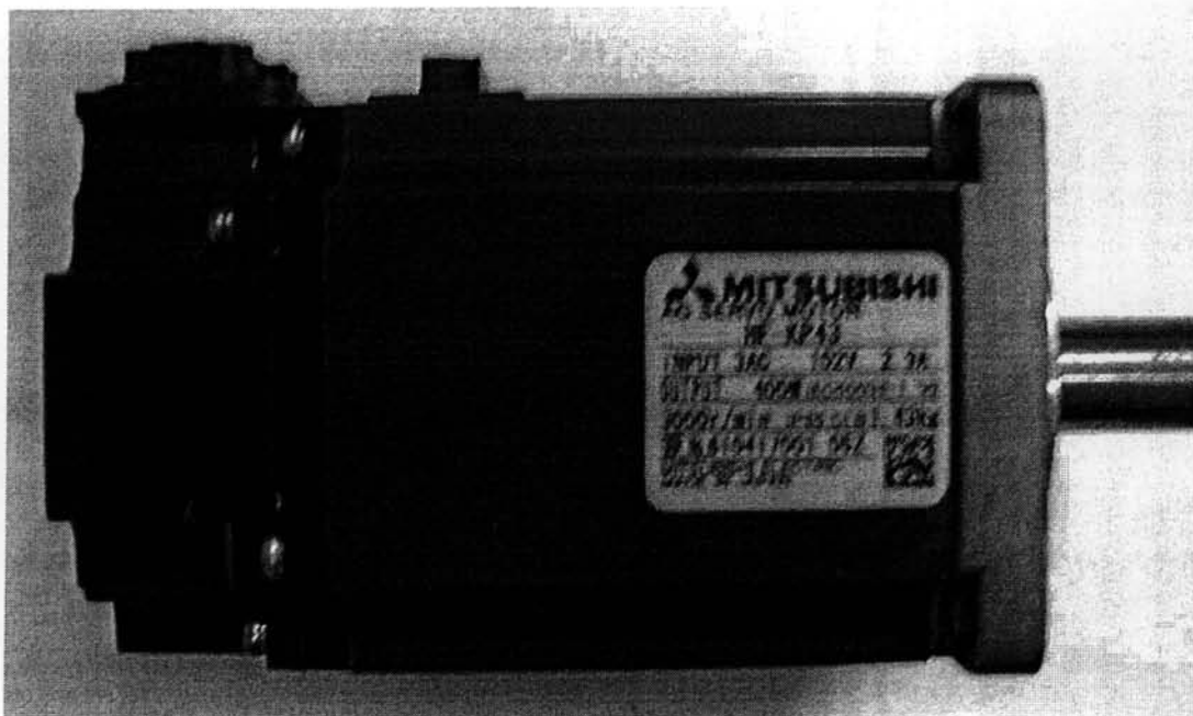
รูปที่ ก.3 มอเตอร์กระแสสลับยี่ห้อ Mitsubishi รุ่น KP43
