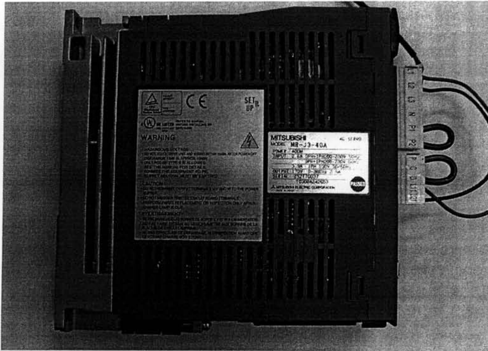
รูปที่ ก.4 ชุดขับเคลื่อนมอเตอร์กระแสสลับยี่ห้อ Mitsubishi รุ่น MR-J3-40A
