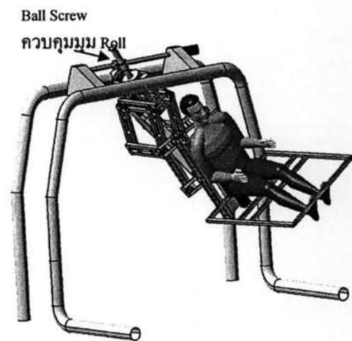
รูปที่ 7 การทำงานของเครื่องขณะจำลองความเร่งด้านข้าง
