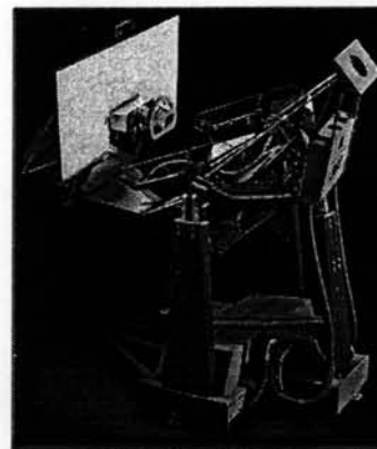
รูปที่ 2 เครื่องจำลองการเคลื่อนที่แบบ UPU 3 องศาอิสระ [12]
