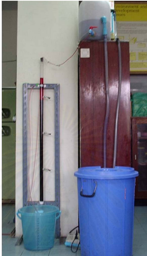
รูปที่ 3.6 คอลัมน์สำหรับการทดลองแบบต่อเนื่อง
