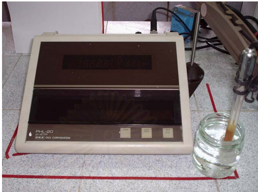
รูปที่ ก-3 เครื่องวัดความเป็นกรด-ด่าง : Desktop pH meter PHL-20, DKK Corporation. Japan
