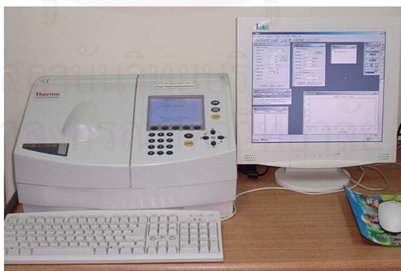
รูปที่ ก-2 สเปคโตรโฟโตมิเตอร์ รุ่น Helios Alpha ควบคุมการทำงานด้วยคอมพิวเตอร์โดยใช้โปรแกรม Vision 32
