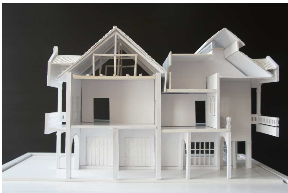
ภาพที่ 2-1 หุ่นจำลองตัดขวางอาคารอนุรักษ์ที่สร้างขึ้นสมัยรัชกาลที่ 5 แบบที่ 1 ที่มา : ฝ่ายบริหารงานอนุรักษ์ สำนักงานทรัพย์สินส่วนพระมหากษัตริย์
