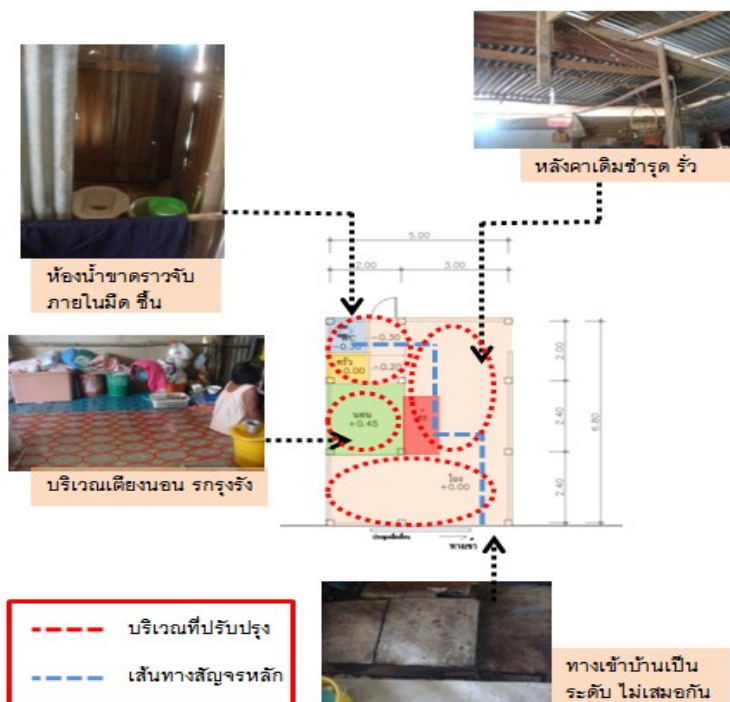
ภาพที่ 5.24 สภาพบ้านก่อนทำการปรับปรุงของ นางหม่อง นุญยัง
