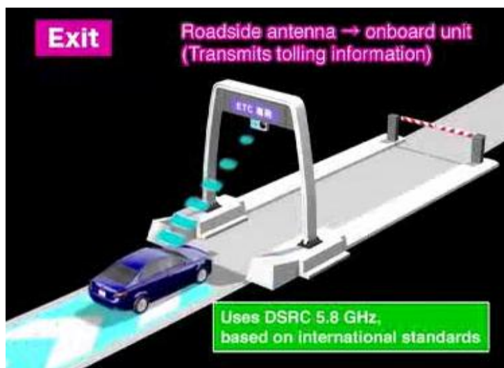
รูปที่ 2.11 อุปกรณ์รับ – ส่งสัญญาณระหว่างรถยนต์กับเครื่องบริเวณหน้าด่าน (ทางออก)
