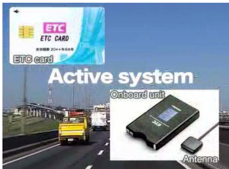
รูปที่ 2.10 อุปกรณ์รับ - ส่งสัญญาณระหว่างรถยนต์กับเครื่องบริเวณหน้าด่าน (ทางเข้า) ที่มา: Hiroshi Makino, 2006.
