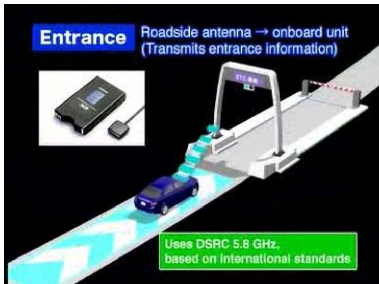
รูปที่ 2.9 อุปกรณ์เครื่องที่ติดตั้งภายในรถยนต์และบัตรเสียบบ ที่มา: Hiroshi Makino, 2006.
