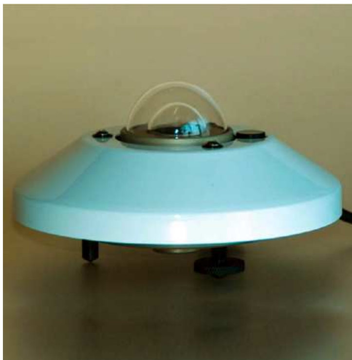
รูปที่ 4.6 เครื่องวัดความเข้มแสงอาทิตย์ (Pyranometer)
