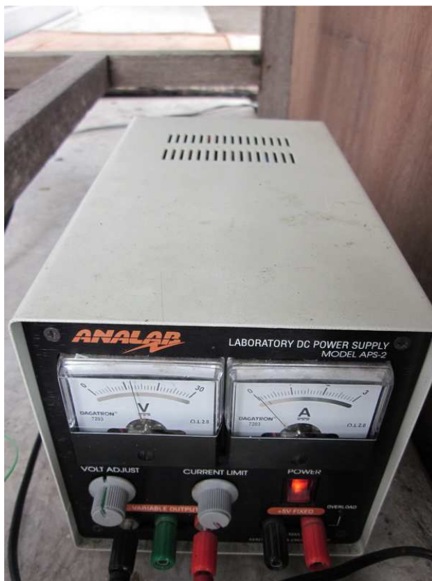
รูปที่ 4.5 เครื่องจ่ายไฟฟ้ากระแสตรง DC Power Supply
