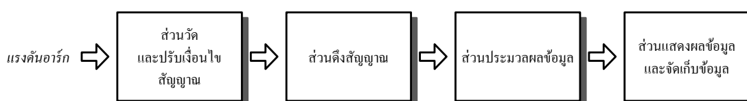
รูปที่ 3.4 แผนภาพบล็อกของระบบตรวจสอบการเกิดฟองสแลก
