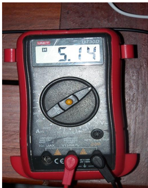
รูปที่ 58 ผลการวัดการจ่ายพลังงานให้กับ Raspberry Pi
