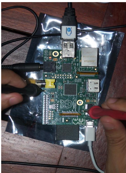
รูปที่ 57 การวัดการจ่ายพลังงานให้กับ Raspberry Pi
