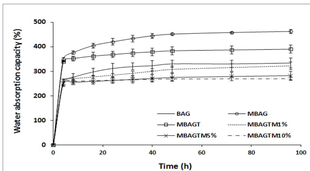
**Figure 4.26** Water absorption capacity (%) of the composite films: BAG (—); MBAG (—○—); MBAGT (—□—); MBAGTM1% (·····); MBAGTM5% (—×—) and MBAGTM10% (----), respectively.
