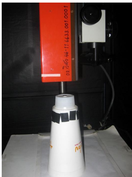
รูปที่ 4 แสดงการถ่ายภาพชิ้นงานด้วยเครื่องกำเนิดรังสีเอกซ์แบบไมโครโฟกัส
