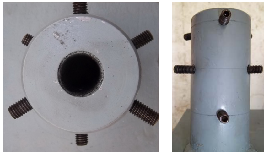
ภาพที่ ก.2 แสดงลักษณะการจับยึดเหล็กเสริมตามยาวที่จุดรองรับ
