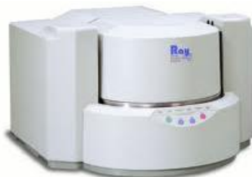
รูปที่ 3.7 เครื่อง Energy-dispersive X-ray spectrometer ยี่ห้อ Shimadzu รุ่น EDX-720/800HS
