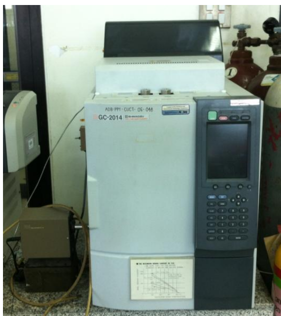
รูปที่ 3.9 เครื่องแก๊สโครมาโทกราฟี ยี่ห้อ Shimadzu รุ่น GC-2014
