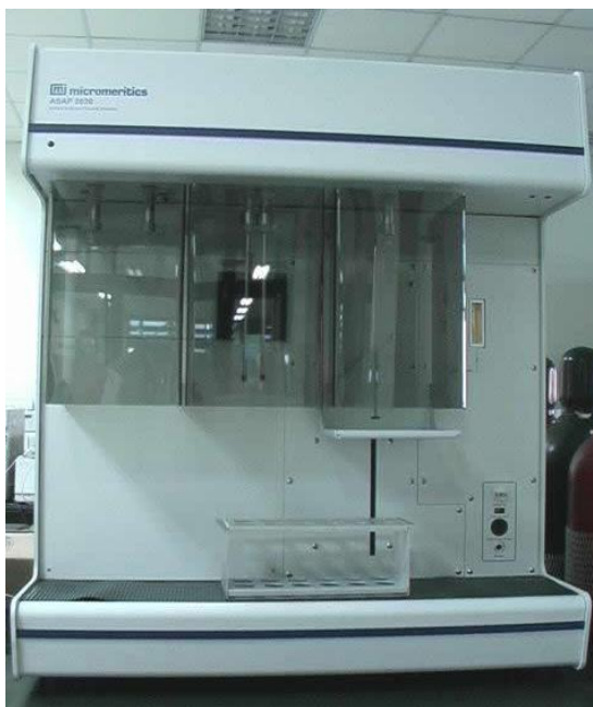
รูปที่ 3.6 เครื่อง Surface area and porosity analyzer ยี่ห้อ Micromeritics รุ่น ASAP 2020
