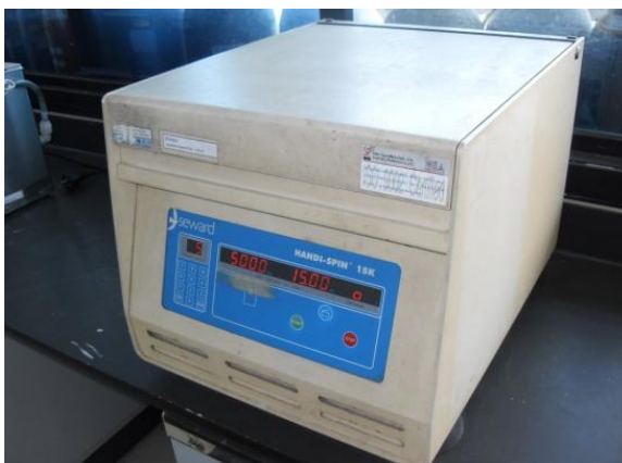
รูปที่ 3.2 เครื่องปั่นเหวี่ยง (centrifuge) ยี่ห้อ Seward รุ่นHANDI-SPIN 15K
