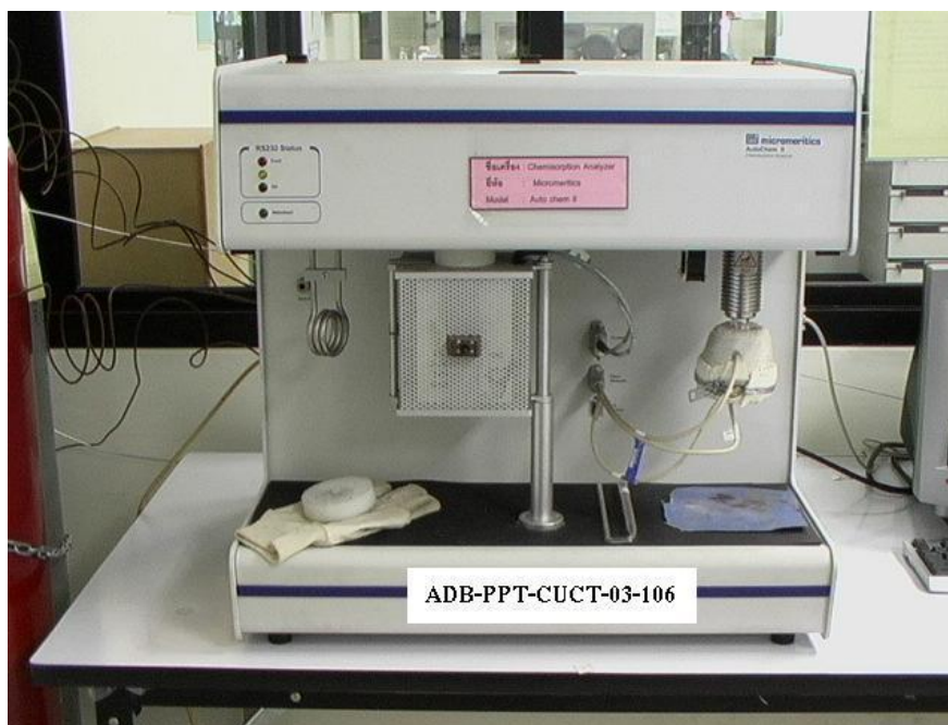
รูปที่ 3.8 เครื่อง Chemisorption analyzer ยี่ห้อ Micromeritics รุ่น AutoChem II
