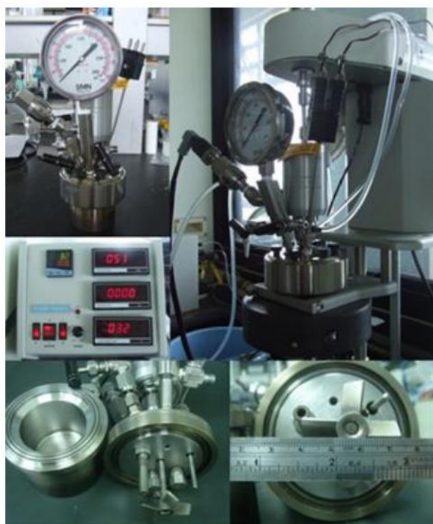
รูปที่ 3.1 เครื่องปฏิกรณ์ความดันและอุณหภูมิสูง ยี่ห้อ Parr ขนาด 100 มิลลิลิตร รองรับความดันสูงสุด 2950 ปอนด์ต่อตารางนิ้ว ที่อุณหภูมิ 350 องศาเซลเซียส
