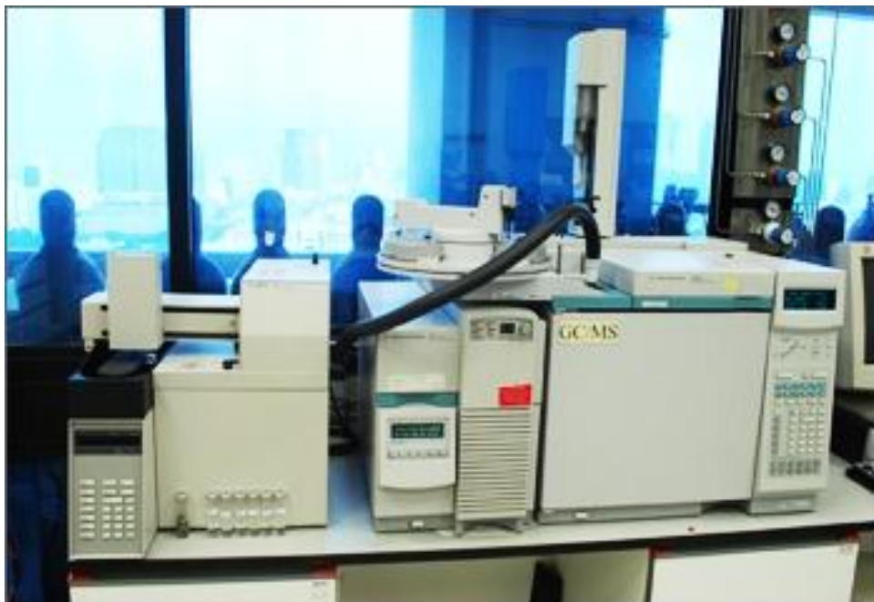
รูปที่ 3.10 เครื่องแก๊สโครมาโทกราฟีและแมสสเปกโตรมิเตอร์ ยี่ห้อ Agilent รุ่น 5975
