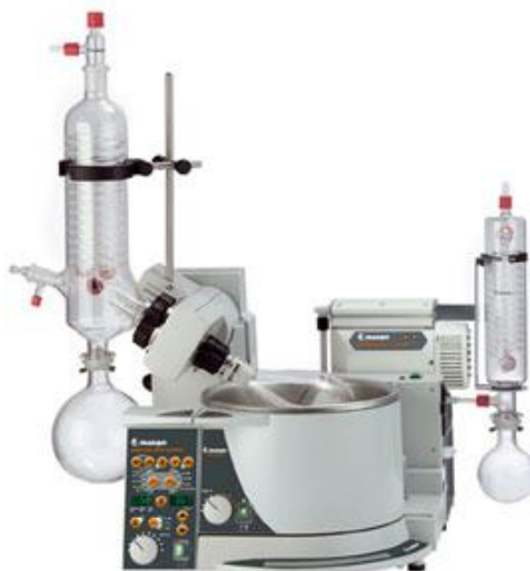
รูปที่ 3.3 เครื่องระเหยแบบหมุน (rotary evaporator) ยี่ห้อ Heidolph รุ่น Laborota 4003
