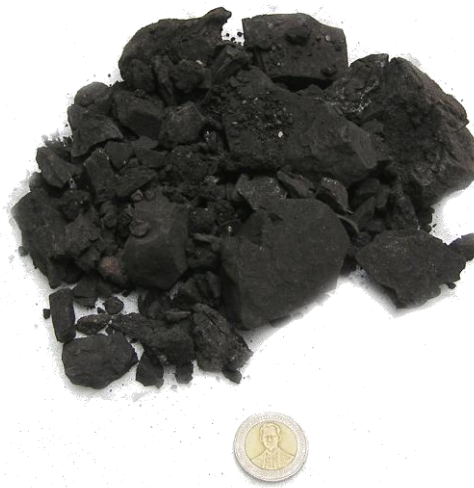
รูปที่ 3.2 ตัวอย่างถ่านหินที่ถ้ำมีปริมาณแคลเซียมออกไซด์ปานกลาง K2 (15.24 %CaO)
