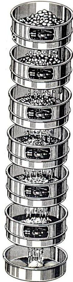
รูปที่ ก4 แสดงวิธีการคัดขนาด ด้วยชั้นของชุดตะแกรงขนาดต่างๆ
