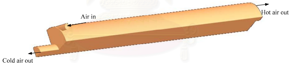
รูปที่ 5.2 โดเมนการคำนวณของท่อออร์เทกซ์แบบไหลสวนทางกัน (Not to scale)
