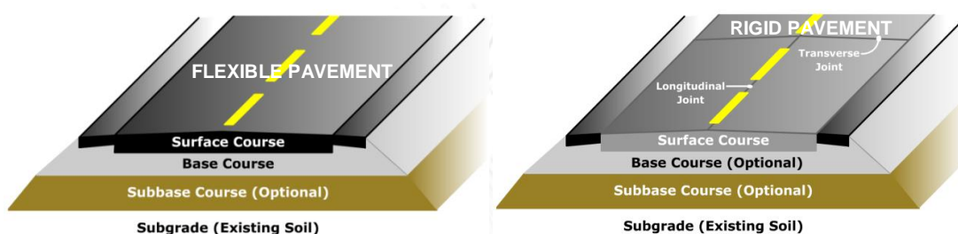
ภาพที่ 2.1 สภาพผิวทางและภาพตัดถนนของผิวทางลาดยางและผิวทางคอนกรีต
