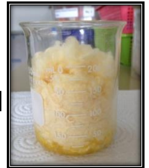
ละลายเส้นใยไฟโบรอิน ในสารละลาย LiBr ที่อุณหภูมิ 60^\circ\text{C}
