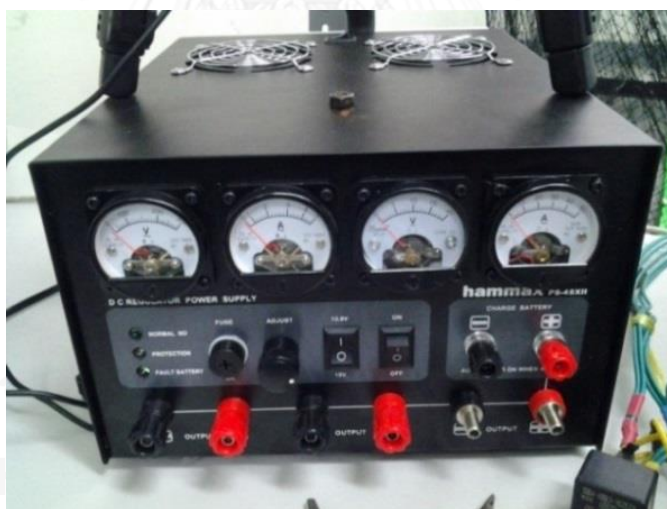
รูปที่ ก. 7 Hammax PS-48XII DC Power Supply
