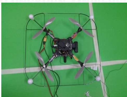
รูปที่ ก. 1 รูปอากาศยาน 4 ใบพัด ASCTEC PELICAN ที่ติดตั้งทรงกลมสะท้อนแสงไว้ที่ตำแหน่งปลายแขนทั้ง 4 ข้าง
