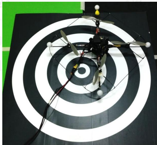
รูปที่ 5. 10 ความแม่นยำในการลงจอดของอากาศยาน ซึ่งอยู่ที่ \pm 20 cm โดยทำการวัดเทียบจากจุดศูนย์กลางของแผ่นเป้าหมาย
