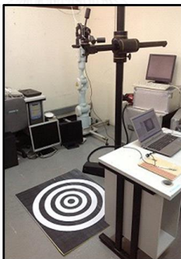
รูปที่ 5. 1 การทดลองเปรียบเทียบความสูงที่ได้จากการประมาณค่าโดยระบบการเห็นภาพเทียบกับความสูงที่วัดได้จริง
