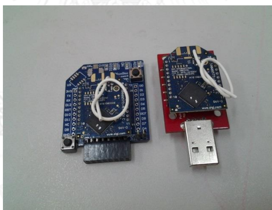
รูปที่ ก. 2 รูปอุปกรณ์ส่งสัญญาณไร้สาย รุ่น XBee Pro 900 XSC
