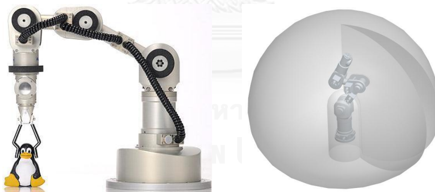
รูปที่ 3.4 ซ้าย) แขนหุ่นยนต์ Katana 6M180 ขวา) ปริภูมิการทำงานของแขนหุ่นยนต์ Katana
