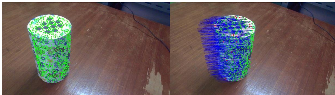
รูปที่ 2.7 ผลลัพธ์การทำงานของ optical flow ซ้าย) ภาพก่อนหน้า ขวา) ภาพปัจจุบันที่แสดงเวกเตอร์ผลลัพธ์ของ optical flow
