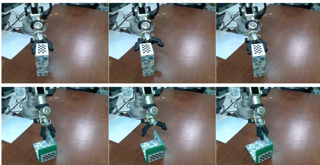
รูปที่ 5.7 ตัวอย่างการเลื่อนตำแหน่งของวัตถุในขณะการวางนิ้วของมือจับ
