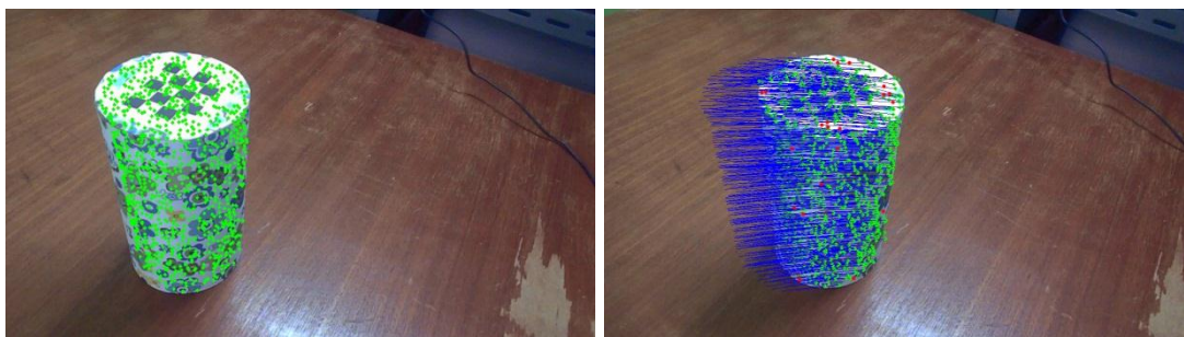
รูปที่ 4.7 ผลลัพธ์การติดตามจุดบนภาพด้วยวิธี optical flow
