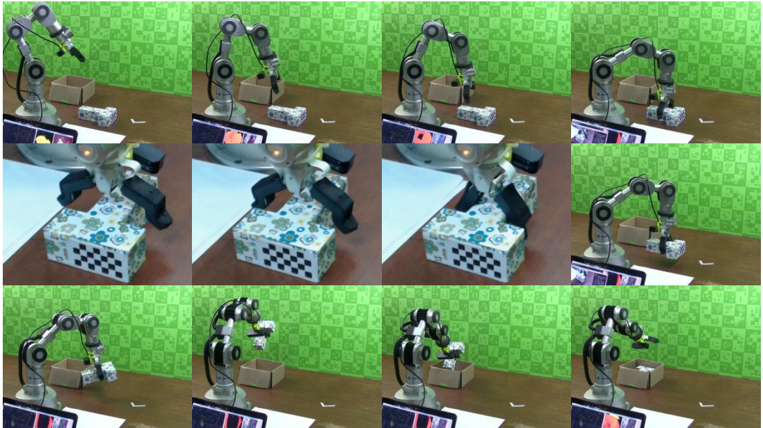
รูปที่ 5.11 ลำดับภาพการทดสอบหยิบและวางวัตถุกล่องรูปตัวที (จากซ้ายไปขวา บนลงล่าง)
