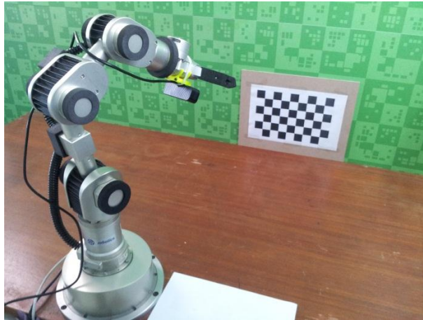
รูปที่ 3.8 การติดตั้งอุปกรณ์สำหรับการปรับแก้ค่าความลึก
