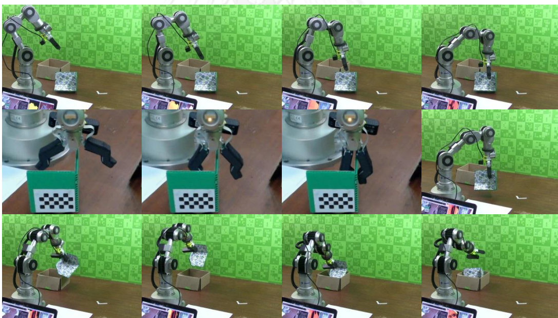
รูปที่ 5.10 ลำดับภาพการทดสอบหยิบและวางวัตถุมุมฉาก (จากซ้ายไปขวา บนลงล่าง)
