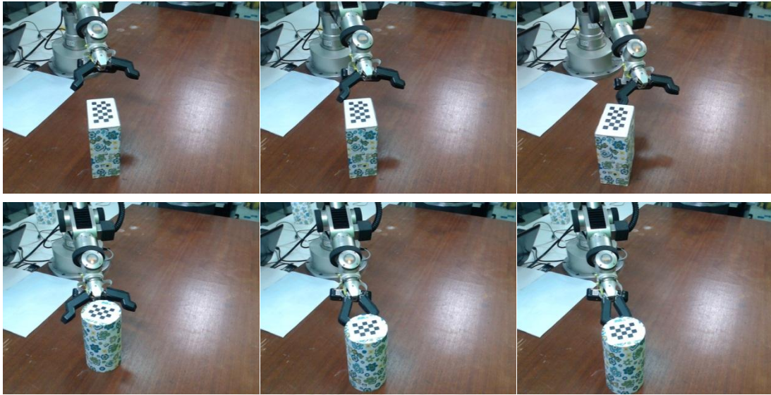
รูปที่ 5.4 ตัวอย่างความล้มเหลวในการวางนิ้ว บน) เกิดการชน ล่าง) เกิดการไถล
