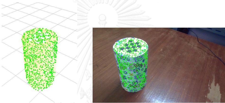
รูปที่ 4.6 การฉายภาพจุดในสามมิติลงบนภาพสีในสองมิติ
