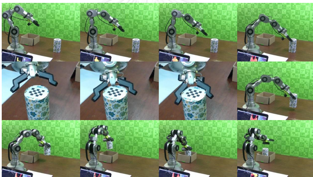
รูปที่ 5.8 ลำดับภาพการทดสอบหยิบและวางวัตถุกล่อง (จากซ้ายไปขวา บนลงล่าง)
