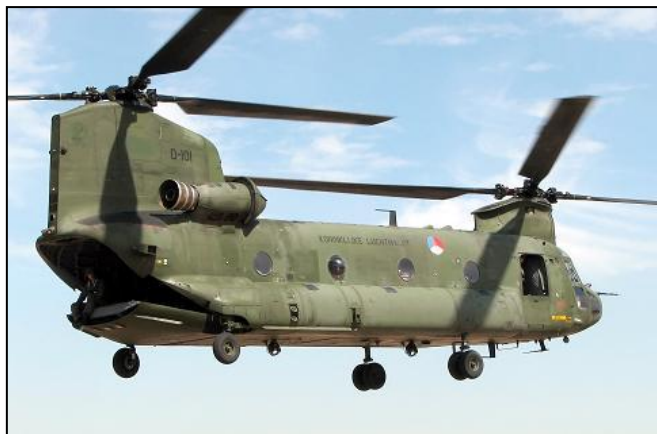
รูปที่ 2. 8 เฮลิคอปเตอร์ชนิดแกนหลักสองแกน
