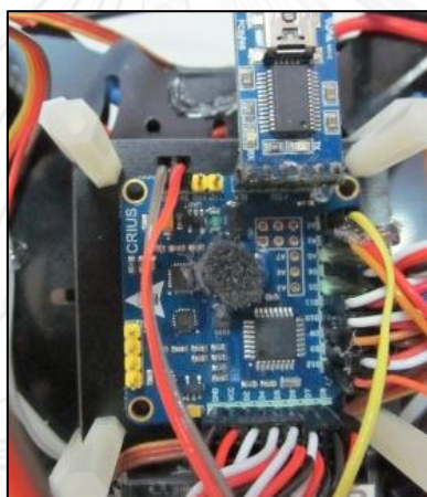
รูปที่ ง. 5 แสดงการเชื่อมต่อโมดูล USB-to-Serial ของบริษัท FTDI กับระบบควบคุมการบิน MultiWii
