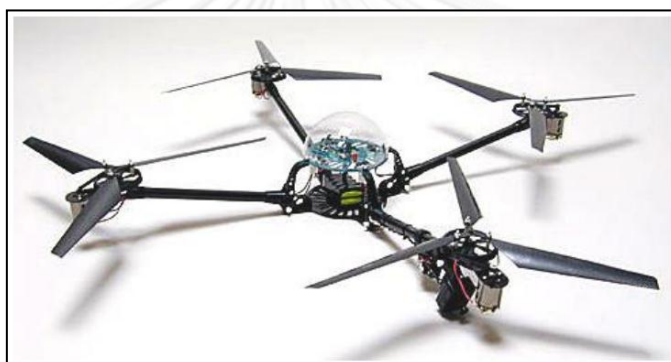
รูปที่ 2. 9 เฮลิคอปเตอร์ชนิดใบพัดเดี่ยวหลายแกน
