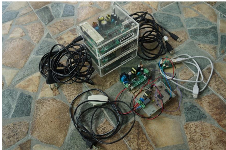
รูปที่ 5-4 โมเด็มการสื่อสารผ่านสายไฟฟ้าส่งกำลัง
