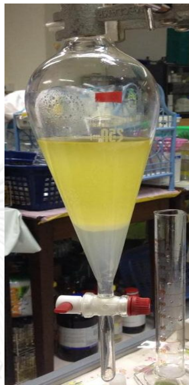
ภาพที่ ง.4 การแยกชั้นของเอสเทอร์ (บน) และน้ำ (ล่าง) จากขั้นตอนการล้างด้วยน้ำ
