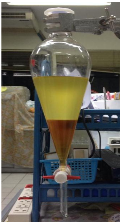
ภาพที่ ง.3 การแยกชั้นของเอสเทอร์ (บน) และกลีเซอรอล (ล่าง)
