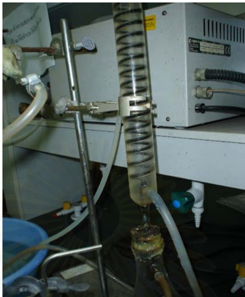
รูปที่ 3.7 เครื่องควบคุมแรงของเหลวออกจากผลิตภัณฑ์แก๊ส
