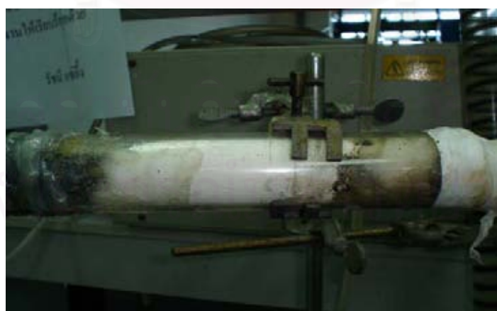
รูปที่ 3.6 เครื่องแยกไอน้ำออกจากผลิตภัณฑ์แก๊สที่ได้
