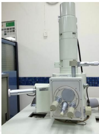
รูปที่ 14 แสดงกล้องจุลทรรศน์อิเล็กตรอนชนิดส่องกราด
