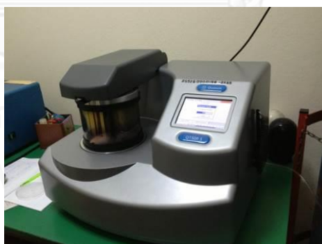
รูปที่ 13 แสดงเครื่องเคลื่อนขึ้นตัวอย่างด้วยอนุภาคทอง
