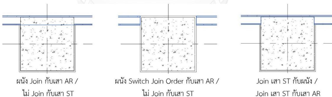
ภาพที่ 3.51 ความสัมพันธ์ระหว่างผนังกับเสาแบบต่างๆ ในการทดลองผนังเบา
