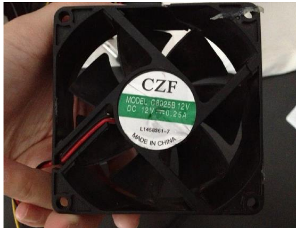
รูปที่ 20 พัดลมดูดอากาศ
