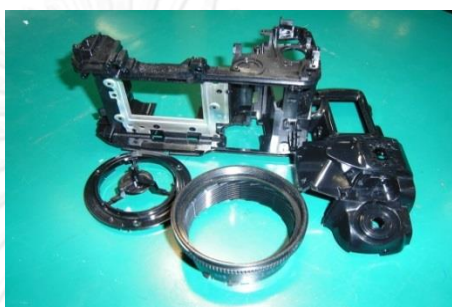
รูปที่ 1.7 ตัวอย่างชิ้นส่วน Molding Parts
