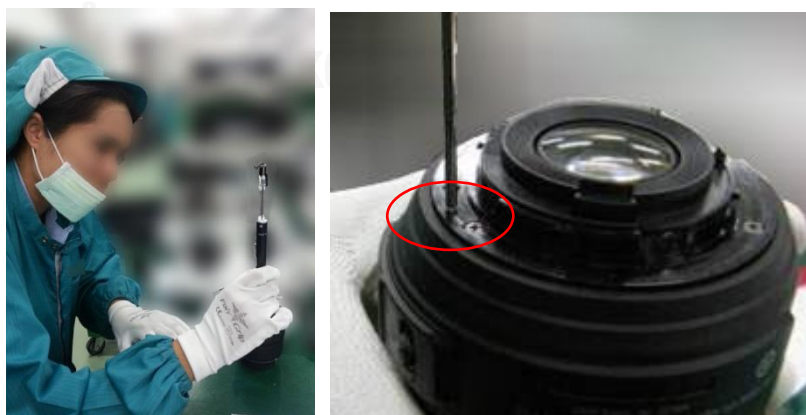
รูปที่ 4.9 ลักษณะการใช้ Tension gage 15C620 เพื่อวัดค่างานหัวข้อ G
