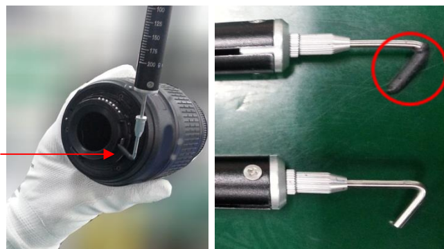
รูปที่ 4.16 เสริมยางหุ้มปลาย Tension gage สำหรับการตรวจสอบงานหัวข้อ A
