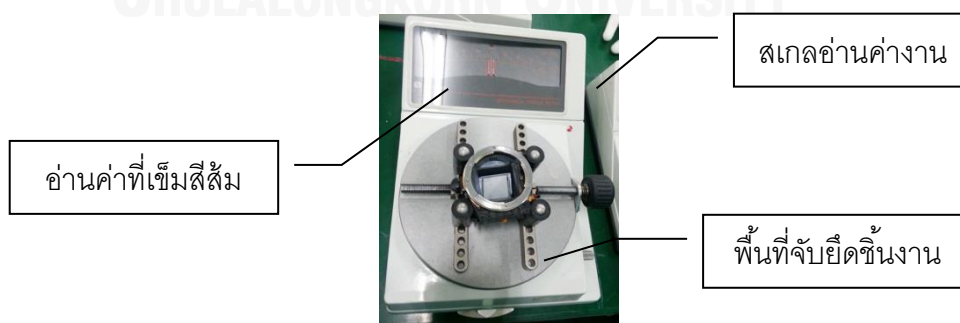
รูปที่ 4.2 เครื่องมือวัด Torque meter - 5017E
