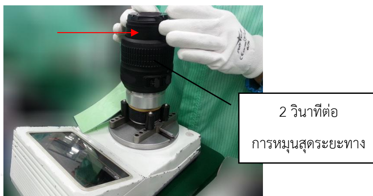
รูปที่ 4.19 มุมการหมุนวงแหวนและเวลาหมุนการตรวจสอบหัวข้อ F
