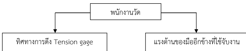
รูปที่ 4.25 แผนผังสรุปการวิเคราะห์สาเหตุความผันแปรของการตรวจสอบหัวข้อ S
