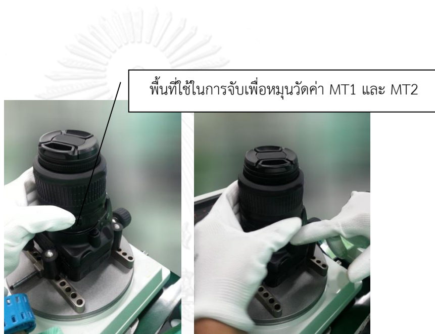
รูปที่ 4.23 บริเวณที่ใช้จับของการตรวจสอบหัวข้อ MT
