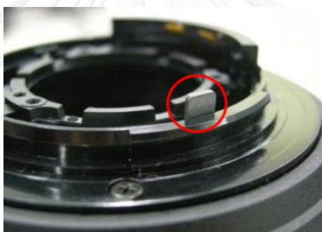
รูปที่ 4.12 ตำแหน่ง Lever ของตัวงานสำหรับการตรวจสอบหัวข้อ A
