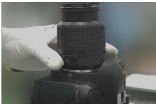
รูปที่ 4.21 เมื่อสวมซุ่มเลนส์เข้ากับตัวกล้องของการตรวจสอบหัวข้อ MT
