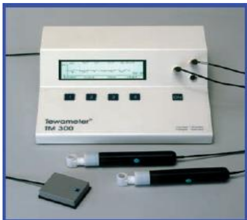
ภาพที่ 8 แสดง Tewameter ® เครื่องมือที่ใช้ในการวัด Transepidermal water loss หรือ TEWL
