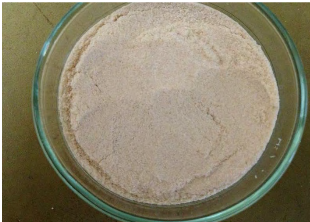
รูป 38 แสดงคาร์โบไฮเดรตที่สกัดด้วยวิธีการตกะกอนด้วยตัวทำละลายอินทรีย์ (TSP-1) และผ่านการลดขนาดด้วยเครื่อง Retsch Zm 1000 (0.5 mm)
