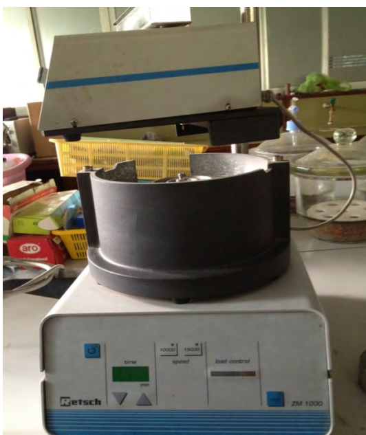
รูป 24 เครื่องปั่นร่อน Retsch ZM 1000 ขนาดรูแรง 0.5 เซนติเมตร
