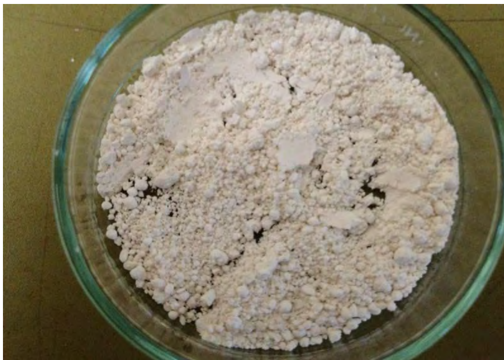
รูป 39 แสดงคาร์โบไฮเดรตที่สกัดด้วยวิธีการพ่นแห้ง (TSP-2) ด้วยเครื่อง Buchi Mini Spray Dryer B-29
