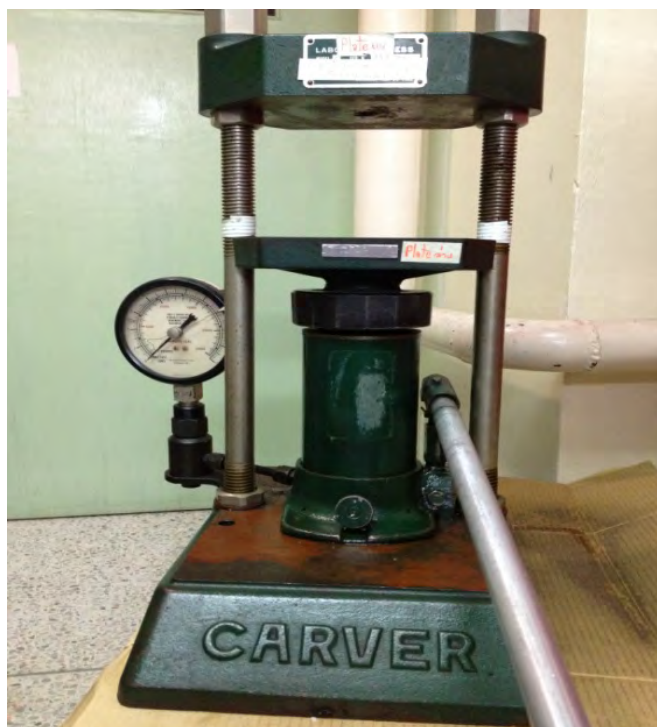
รูป 31 เครื่องตอกอัด KBr Disc แบบไฮดรอลิก
