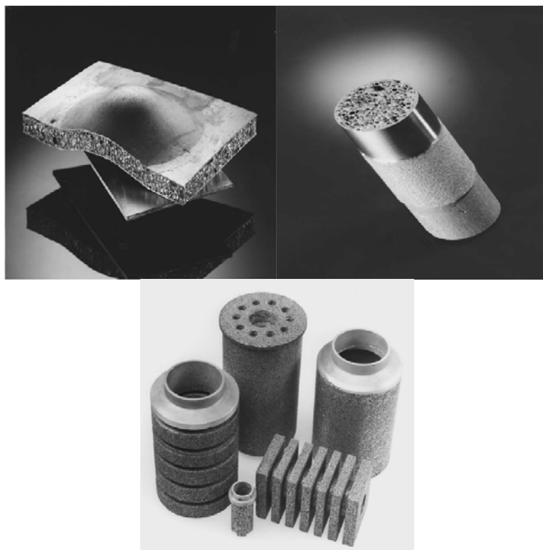
รูปที่ 2.3 โฟมอะลูมิเนียมรูปทรงต่างๆ สำหรับการใช้งานที่แตกต่างกัน [2]
