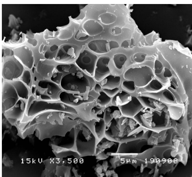
ภาพที่ 4.4 ลักษณะสัณฐานวิทยาของถ่านกัมมันต์ทางการค้าจากกะลามะพร้าว ที่กำลังขยาย 3,500 เท่า
