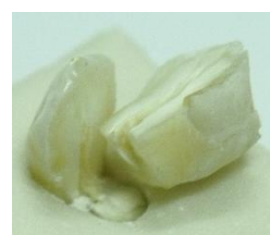
(ง) ชั้นงานที่ 9 แตกหักที่ 2,073 รอบการเคี้ยว
