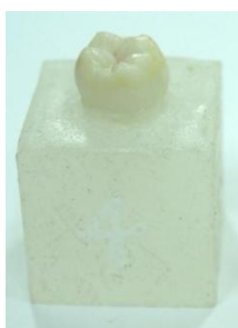
รูปที่ 4.12 ชิ้นงานฟันกรามของมนุษย์ที่หล่อติดกับเรซิน
