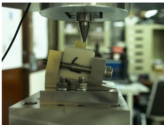
รูปที่ 5.16 การจัดตำแหน่งการขบกันระหว่างชิ้นงานและหัวกดชิ้นงาน สำหรับการทดลองการทดลองการเสียหายของชิ้นงานจนกระทั่งชิ้นงานแตกหัก วิธีการเคี้ยวแบบการกระแทกแนวตั้ง
