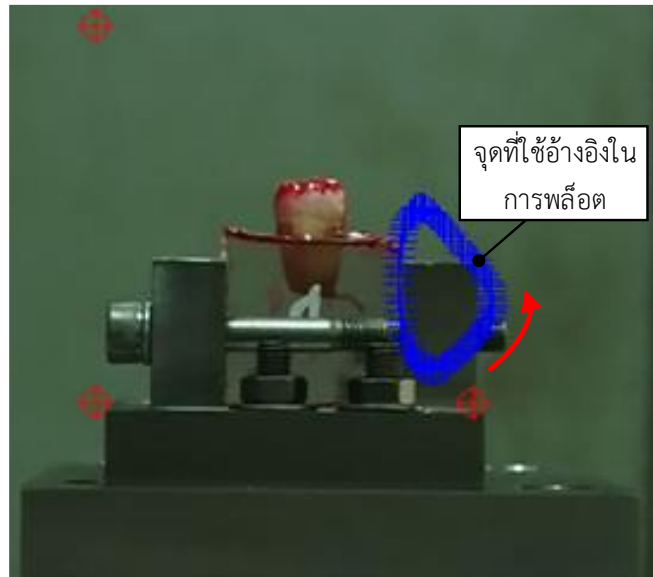
รูปที่ 4.4 การพล็อตตำแหน่งวิถีการเคลื่อนที่จากการถ่ายภาพวิดีโอ
