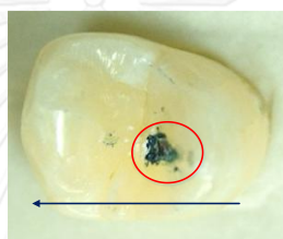
รูปที่ 5.8 การตรวจสอบหน้าสัมผัสที่หักกุดชิ้นงานกระทำต่อชิ้นงานสำหรับการทดลองวิธีการเคี้ยวแบบการกระแทกแนวตั้ง
