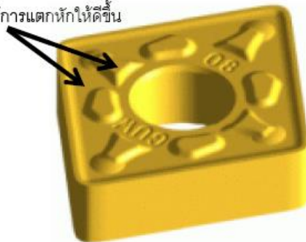
รูปที่ 2.21 เม็ดยัดกึ่งเคลือบผิวคาร์ไบด์ที่มีลักษณะเป็นร่องนูน สูงต่ำเพื่อช่วยให้เศษโลหะโค้งตัวเกิดแตกหักในขณะตัด [27]
