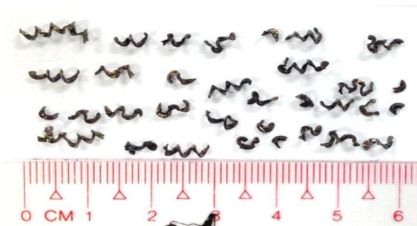
รูปที่ 5.2 ตัวอย่างเศษโลหะแตกหัก ที่ขนาดการสีกหรือของเม็ดมีดถึงเท่ากับ 0.18 มิลลิเมตร อัตราการป้อนตัด 0.25 มิลลิเมตรต่อรอบ ความเร็วตัด 200 เมตรต่อนาที และความลึกตัด 0.8 มิลลิเมตร
