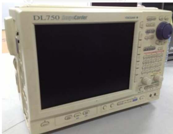
รูปที่ 3.7 เครื่องออสซิลโลสโคปสำหรับแสดงผลและบันทึกค่าแรงตัด
