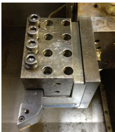
รูปที่ 3.5 ไดนาโมมิเตอร์หรือเซนเซอร์วัดแรงตัดยี่ห้อKISTLER รุ่น 9121
