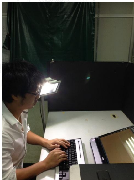
รูปที่ ง.4 ขณะทำการทดลองที่ใช้ปริมาณแสงสว่างในห้อง 1600 ลักซ์และมุมเอียง 70 องศา
