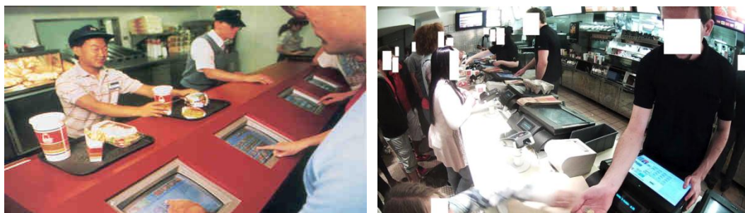
รูปที่ 2.19 การใช้งานคอมพิวเตอร์ในรูปแบบที่มุมของการทำงานเอียงในระดับ 70 องศา
