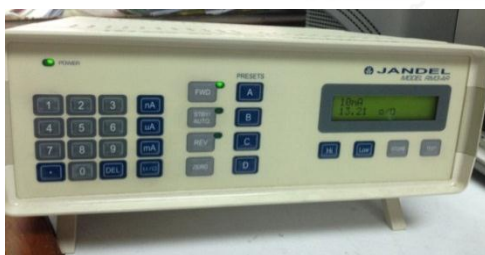
ภาพที่ ค.1 เครื่องวัดค่าการนำไฟฟ้าในแนวแกนด้วยเทคนิค Four point probe
