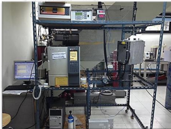
รูปที่ 3.14 ไดอะแกรมเครื่องปฏิกรณ์สำหรับการสังเคราะห์ปิโตรเลียมเหลว
