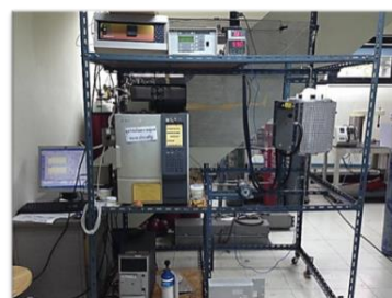
เครื่องปฏิกรณ์สำหรับ สังเคราะห์แก๊สปิโตรเลียมเหลว
