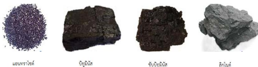
รูปที่ 2.13 ลักษณะของถ่านหินแต่ละชนิด [22]
