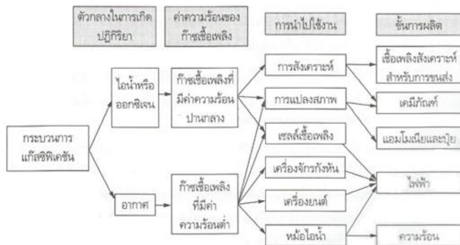
รูปที่ 2.7 การผลิตแก๊สเชื้อเพลิงและการนำมาใช้ประโยชน์ [15]
