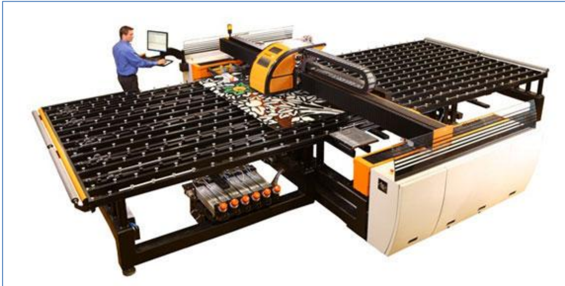
ภาพที่ ก. 10 กระบวนการพิมพ์สีบนผิวกระจก (Printing Glass) [23]
