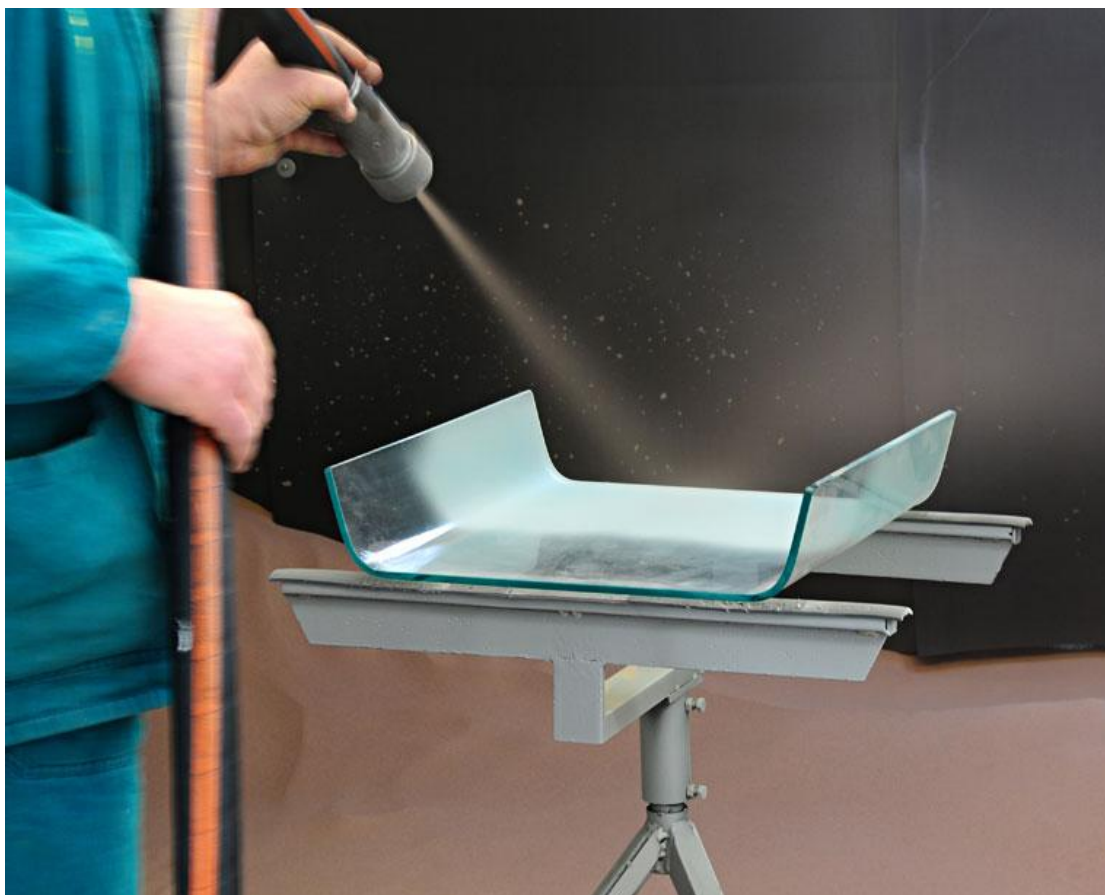
ภาพที่ ก. 8 กระบวนการพ่นทรายกระจก (Glass Sandblasting Process) [21]
