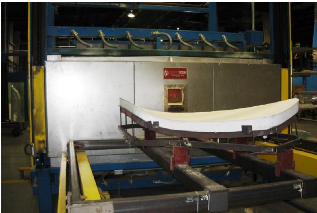
ภาพที่ ก. 7 เครื่องจักรสำหรับกระบวนการตัดโค้งกระจก (Bending Glass Process) [20]
