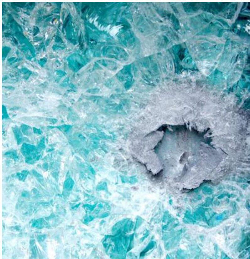
ภาพที่ ก. 20 กระจกลามิเนตกันกระสุน (Bullet Resistant Laminated glass) [33]
