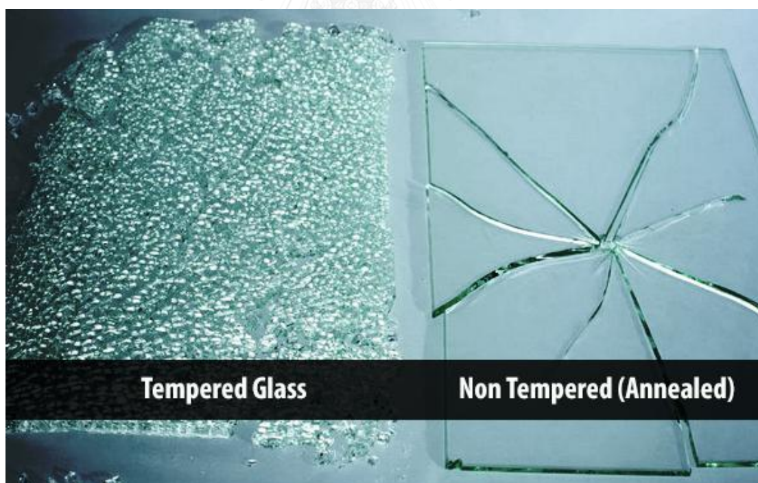
ภาพที่ ก. 15 ลักษณะการแตกของกระจกเทมเปอร์ [28]
