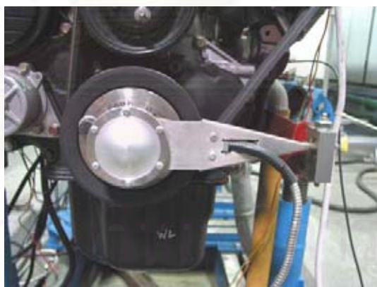
รูปที่ 6-20 Crank Angle Encoder ที่ต่อเข้ากับเฟลาข้อเหวี่ยงของเครื่องยนต์ทดสอบ
