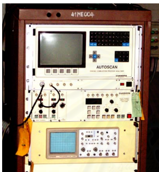
รูปที่ 6-8 แสดงภาพของเครื่อง Cussons P4500 (Autoscan)
