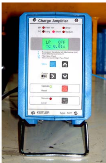
รูปที่ 6-13 แสดงภาพของ Charge Amplifier ยี่ห้อ KISTLER รุ่น 5011b11
