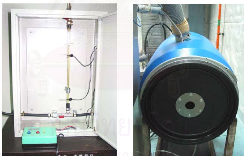
รูปที่ 6-4 แสดงเครื่องวัดอัตราการไหลน้ำมันเชื้อเพลิงและอัตราการไหลของอากาศ
