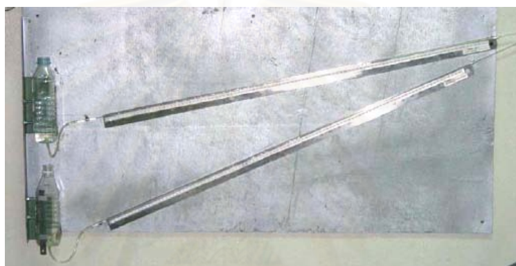
รูปที่ 6-5 แสดงมานอมิเตอร์แบบเอียงที่ใช้ในการวัดความดันตกคร่อม
