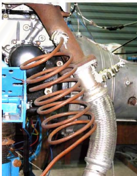
รูปที่ 6-7 แสดงท่อขาดลดอุณหภูมิและตำแหน่งการวัดความดันและอุณหภูมิไอเสีย
