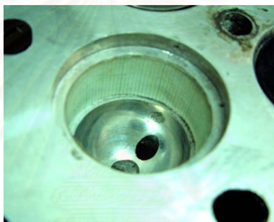
รูปที่ 6-32 การปรับเทียบขนาดของห้องเผาไหม้ล่วงหน้าโดยการทำสเกลวัดระยะ
