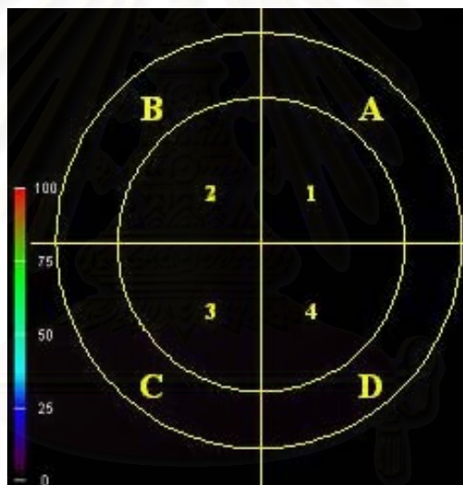
รูปที่ 6-35 การแบ่งพื้นที่เป็น 8 ส่วนเพื่อพิจารณาแนวโน้มของทิศทางการเคลื่อนที่ของเปลวไฟ
