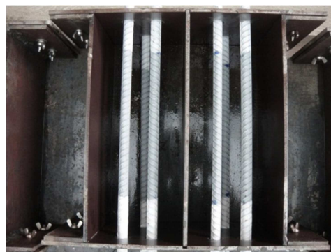
(ข) เสียบเหล็กเข้าไปในแบบหล่อ
