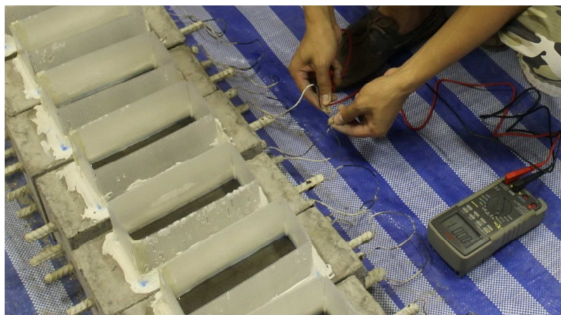
รูปที่ 3.10 การวัดค่าความต่างศักย์ที่คร่อมตัวต้านทานโดยใช้โวลท์มิเตอร์
