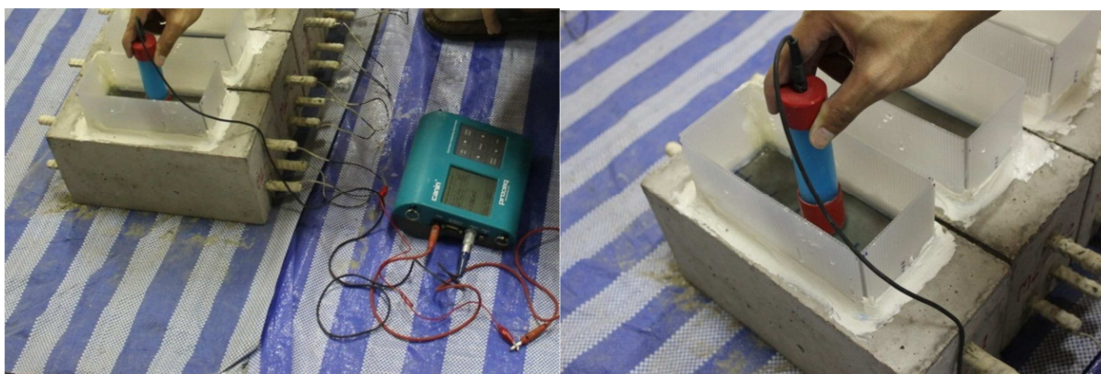
รูปที่ 3.9 การวัดความต่างศักย์ไฟฟ้า โดย Half-cell potential
