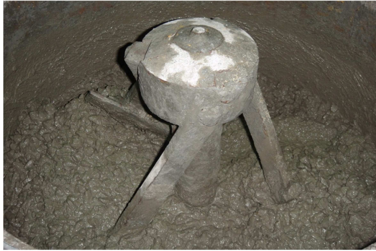
รูปที่ 3.4 การผสมคอนกรีตตามสัดส่วนผสม
