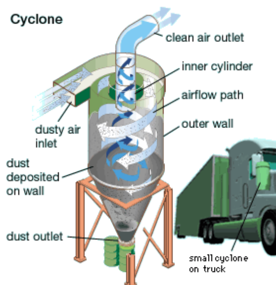
รูปที่ 2. 11 เครื่องแยกฝุ่นแบบลมหมุน (cyclone Separator)
