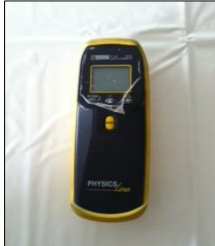
รูปที่ 3. 2 เทอร์โมมิเตอร์อินฟราเรดแบบไม่สัมผัส CHAUVIN ARNOUX รุ่น C.A 876 ชนิด k
