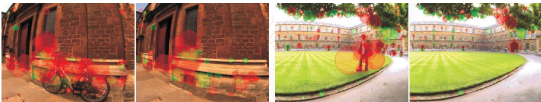
รูปที่ 6.1 ผลลัพธ์คู่ภาพจากอัลกอริทึม FAB-MAP [80] ซึ่งสามารถตรวจพบ loop closure
