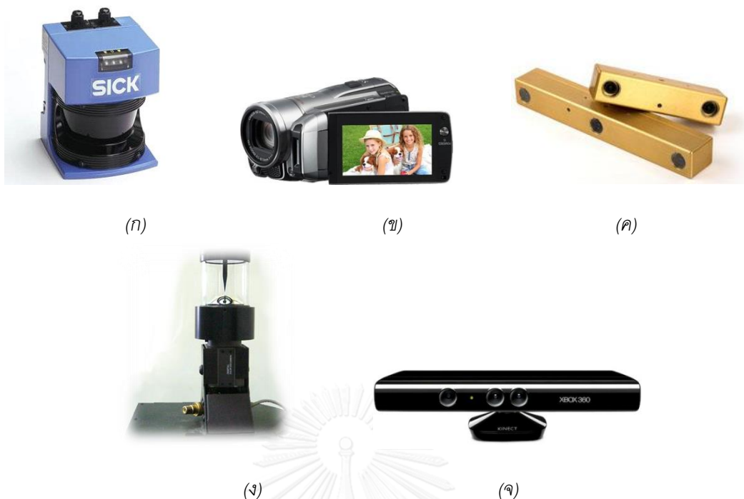
รูปที่ 1.1 อุปกรณ์วัดค่า (ก) อุปกรณ์วัดระยะด้วยเลเซอร์, (ข) กล้องวิดีโอ, (ค) กล้องวิดีโอแบบสเตอริโอ, (ง) กล้องวิดีโอแบบออปติคัล, (จ) กล้องวิดีโอแบบ RGB-D
