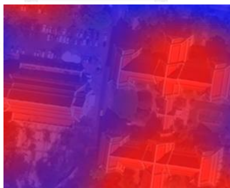
รูปที่ 6.5 แสดงแผนที่ความน่าจะเป็นของการเกิด loop closure
