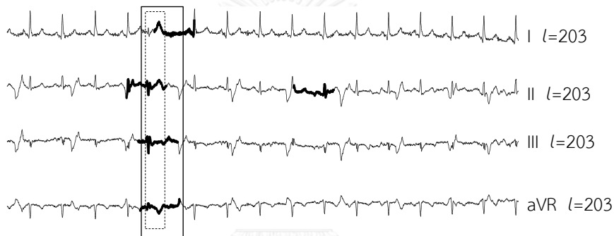
ภาพที่ 4.32 ปีกผิดปกติที่ค้นพบจากอัลกอริทึม BFDD ใน ลีด I ลีด II ลีด III และลีด aVR ของข้อมูล INCARTDB07 โดยเกิดสัญญาณเตือนผิดพลาดขึ้นที่ลีด II เมื่อระยะเวลายาว 203 ให้อัลกอริทึม
