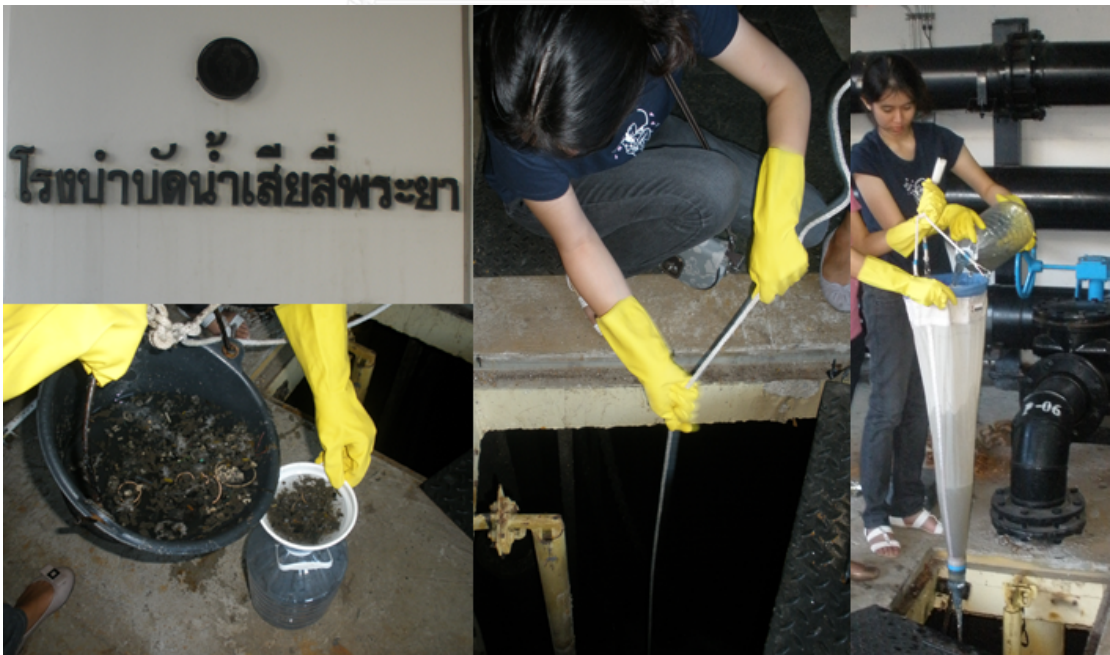
ภาพที่ 3 การเก็บตัวอย่างน้ำจากบ่อรวมน้ำเสีย โรงควบคุมคุณภาพน้ำสีพระยา เขตบางรัก กรุงเทพมหานคร และกรองผ่านถุงลากลากแพลงก์ตอน
