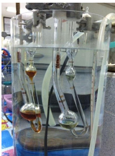
ภาพที่ 3-5 หลอดวัดความหนืดชนิด Canon-Fenske ในอ่างที่ควบคุมอุณหภูมิ
