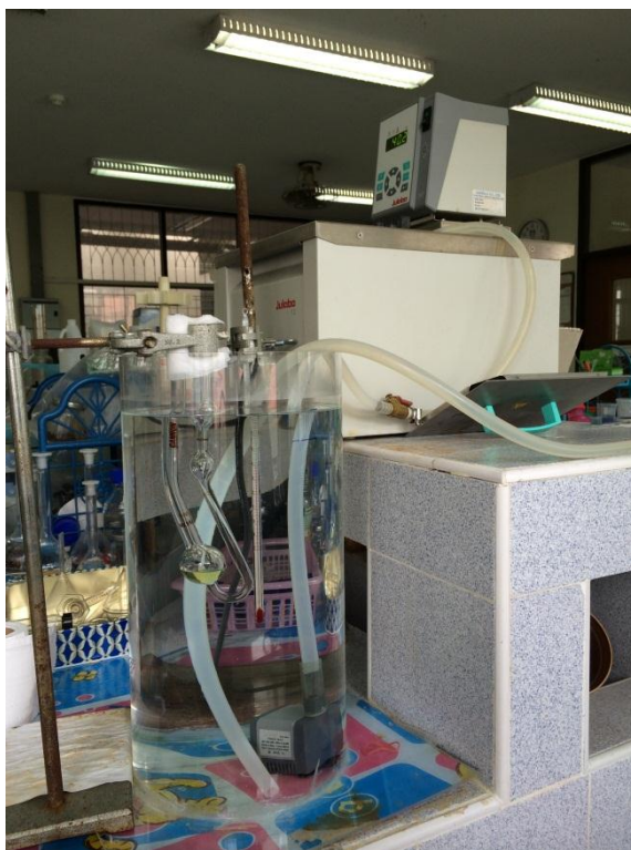
ภาพที่ ก-1 การติดตั้งอุปกรณ์ในการวัดความหนืดเชิงจลนศาสตร์ ของเชื้อเพลิงชีวภาพ ที่อุณหภูมิตั้งที่ 40 องศาเซลเซียส
