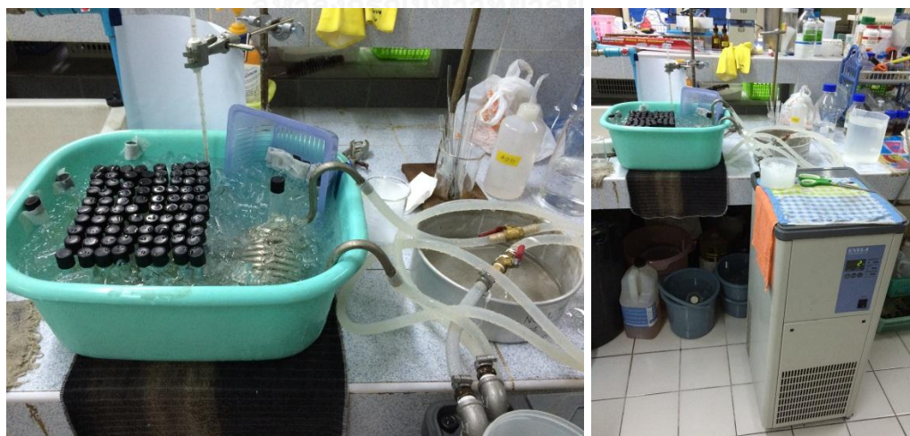
ภาพที่ ก-2 การติดตั้งอุปกรณ์ในการวัดจุดไหลเทของเชื้อเพลิงชีวภาพไมโครอิมัลชัน
