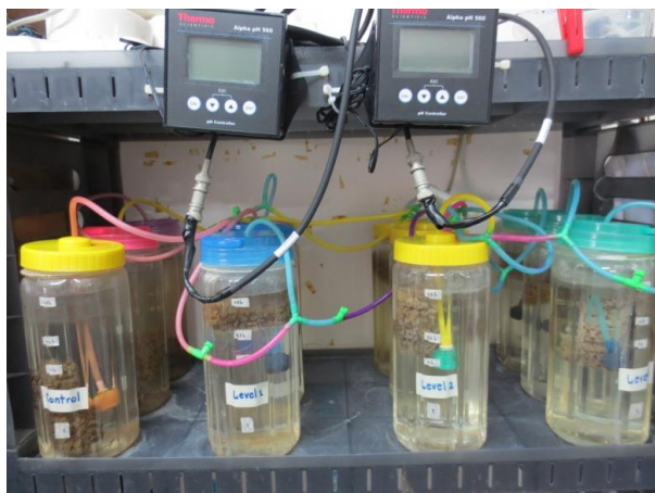
รูปที่ 3.10 การติดตั้งถังปฏิกรณ์สำหรับประเมินอัตราไนทรีฟิเคชันและดีไนทรีฟิเคชัน เมื่อแปรเปลี่ยนวิธีการล้างทำความสะอาดตัวกรองชีวภาพไบโอคอร์ด
