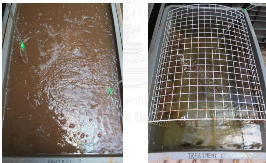
รูปที่ 4.31 เปรียบเทียบปริมาณตะกอนแขวนลอยในระบบเลี้ยงสัตว์น้ำระหว่างชุดควบคุมและชุดทดลองที่มีการติดตั้งตัวกรองชีวภาพไบโอคาร์ดในวันที่ 10 ของการทดลอง
