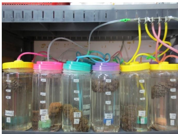
รูปที่ 3. 9 การติดตั้งถังปฏิกรณ์สำหรับประเมินอัตราไนทริฟิเคชันและดีไนทริฟิเคชันของตัวกรองชีวภาพไบโอคอร์ดเมื่อแปรค่าสัดส่วนการเติมคาร์บอนต่อไนโตรเจนในระบบ
