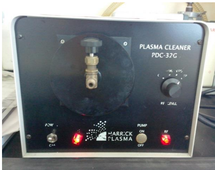
รูปที่ 4.8 เครื่องพลาสมาคลื่นเนอร์ (plasma cleaner)
