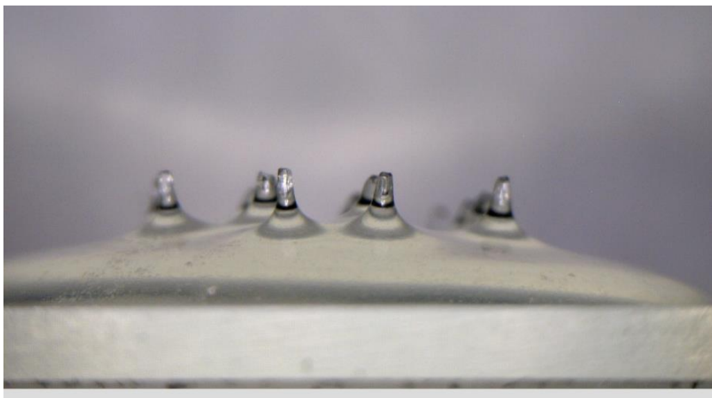
รูปที่ 3.17 ภาพขยายตัวต้นแบบเข็มฉีดยาขนาดไมครอนที่สร้างด้วยกาวร้อน (hot melt adhesive)
