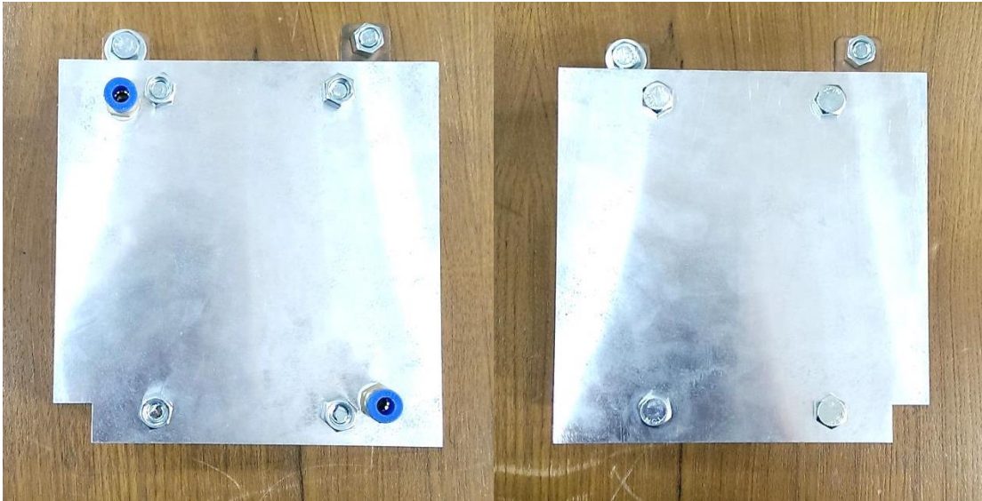
ภาพที่ 41 แผ่นประกับริมหัวท้ายฝั่งแอโนด (ซ้าย) และแคโทด (ขวา)
