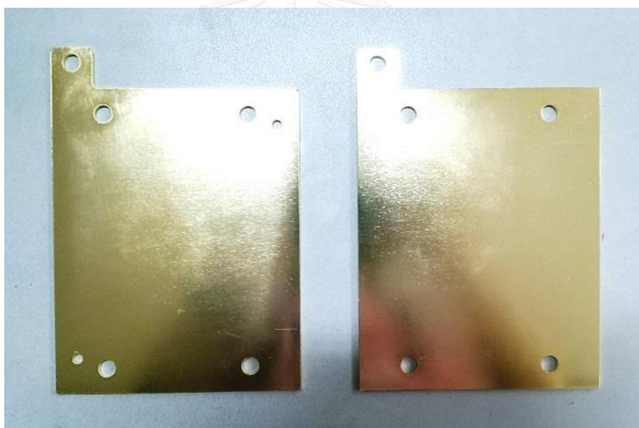
ภาพที่ 39 แผ่นรวมกระแสดังแอนด (ซ้าย) และแคโธด (ขวา)
