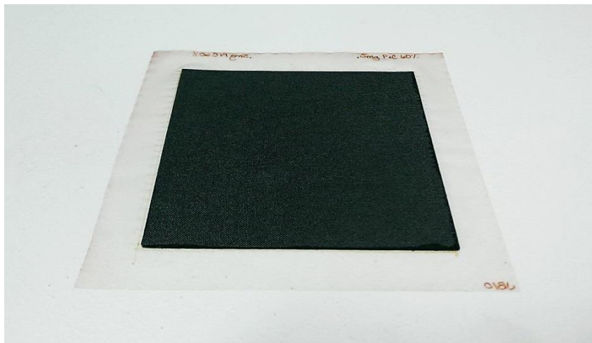
ภาพที่ 31 แผ่น MEA จาก FuelCellsEtc
