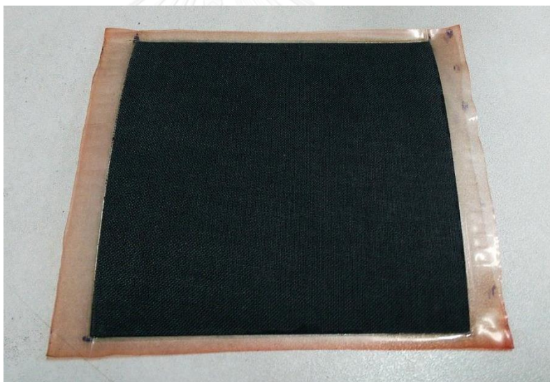
ภาพที่ 121 แผ่น MEA ก่อนทำการทดสอบ ผลกระทบของลักษณะรูพรุนบนแผ่นรูพรุนต่อสมรรถนะของเซลล์เชื้อเพลิง
