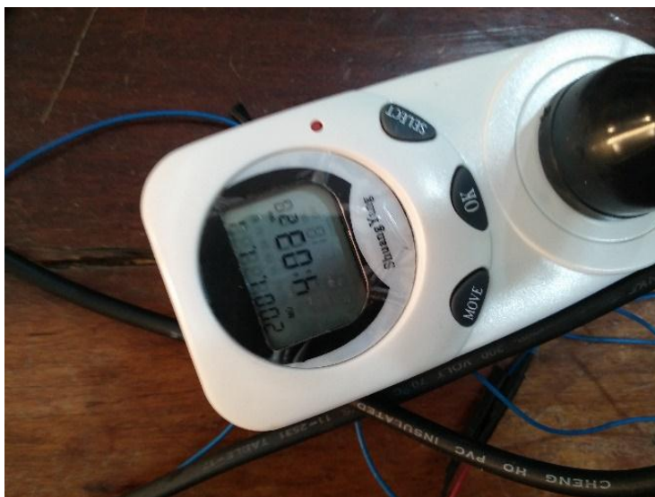
รูปที่ 14 อุปกรณ์ตั้งเวลา
