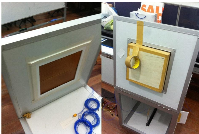
รูปที่ 18 แสดงการนำวัตถุทดสอบที่เตรียมไว้มาติดตั้งที่กล่องทดลอง
