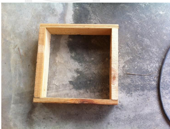
รูปที่ 7 แสดงการประกอบโครงเคร่าไม้
