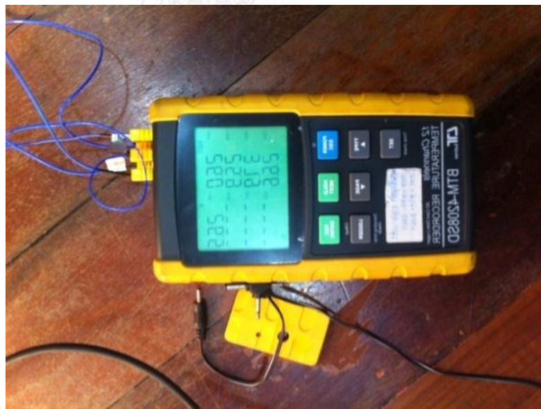
รูปที่ 13 Thermometer 12 channels-SD Card Data logger รุ่น BTM-4208 sd
