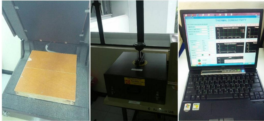
รูปที่ 26 นำผนังทดสอบเข้าเครื่องวัดค่าการนำความร้อน B480
