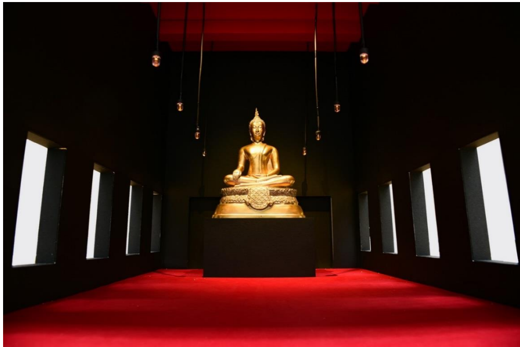
ภาพที่ 3.3 แบบจำลองที่ไม่มีองค์ประกอบงานสถาปัตยกรรมเสาร่วมใน ไม่มีองค์ประกอบแสงไฟฟ้าเหนือช่องเปิด ค่าความเปรียบต่างของความสว่างระหว่างวัตถุและพื้นหลัง 30:1
