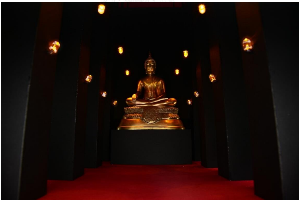
ภาพที่ 3.10 แบบจำลองที่มีองค์ประกอบงานสถาปัตยกรรมเสาร่วมใน มีองค์ประกอบแสงไฟฟ้าไฟกิ่ง ค่าความเปรียบต่างของแสงสว่างระหว่างวัตถุและพื้นหลัง 5:1
