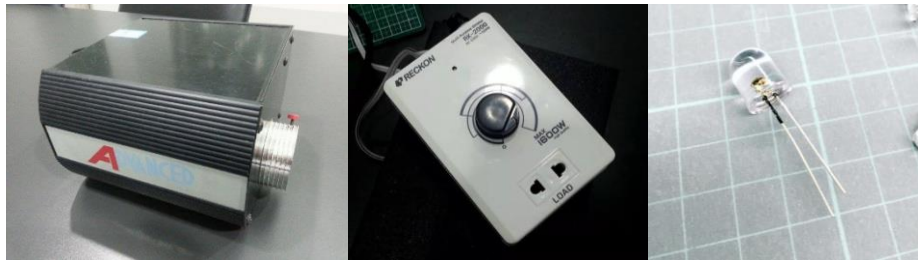
ภาพที่ 3.1.16 อุปกรณ์แทนองค์ประกอบแสงไฟฟ้าที่ใช้สำหรับการสร้างแบบจำลอง แหล่งกำเนิดแสงไฟเบอร์ออฟติก (ซ้าย) ตัวหรีไฟ (กลาง) หลอด LED (ขวา)
