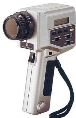
ภาพที่ 3.1.2 อุปกรณ์ luminance meter
