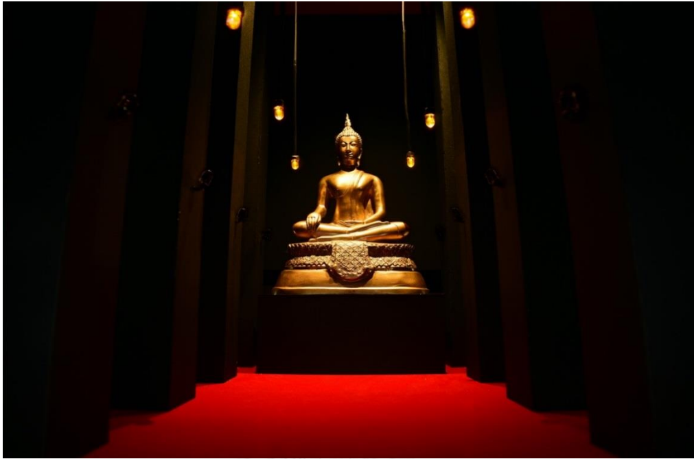
ภาพที่ 3.9 แบบจำลองที่มีองค์ประกอบงานสถาปัตยกรรมเสาร่วมใน ไม่มีองค์ประกอบแสงไฟฟ้าไฟกิ่ง ค่าความเปรียบต่างของแสงสว่างระหว่างวัตถุและพื้นหลัง 30:1
