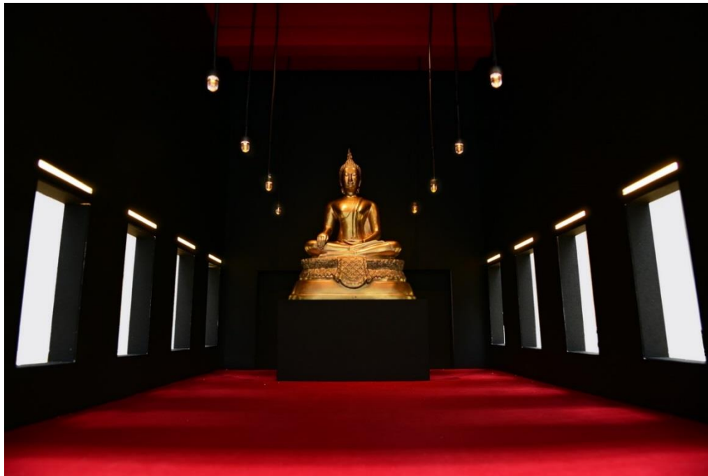
ภาพที่ 3.5 แบบจำลองที่ไม่มีองค์ประกอบงานสถาปัตยกรรมเสาร่วมใน มืองค์ประกอบแสงไฟฟ้าเหนือ ช่องเปิด ค่าความเปรียบต่างของความสว่างระหว่างวัตถุและพื้นหลัง 15:1
