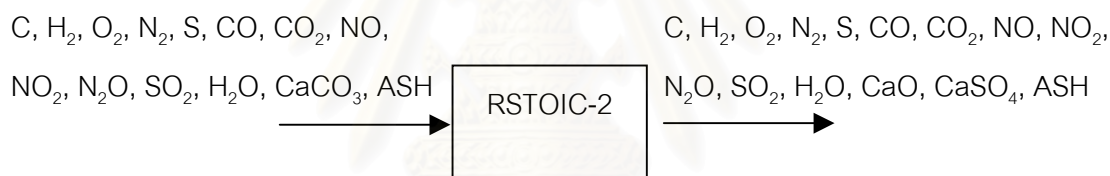
รูปที่3.6 แผนภาพบล็อกปฏิบัติการ RSTOIC-2
